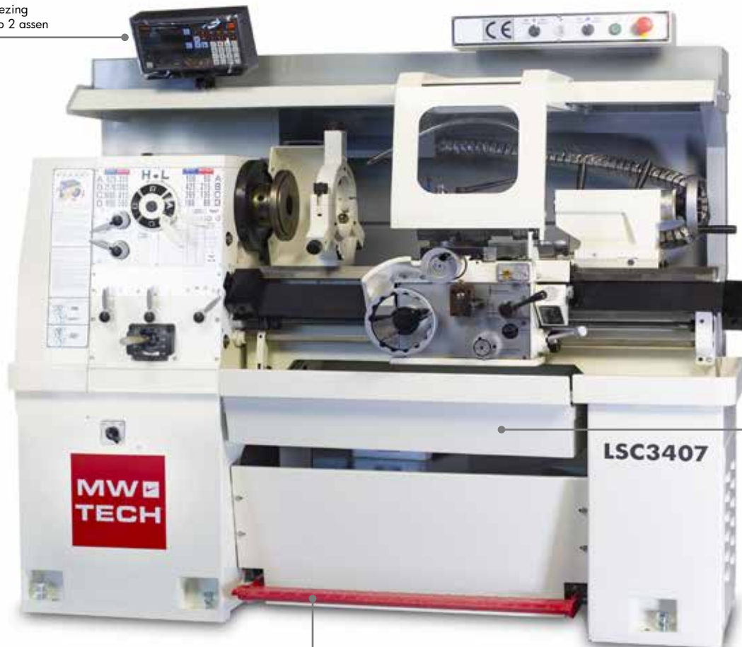
Elektromagnetische rem en voetbediende noodstop rem
