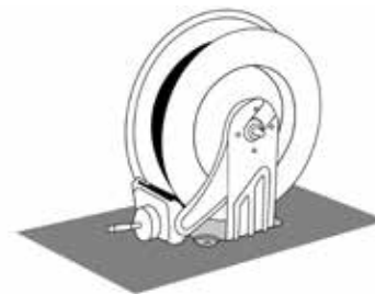
Installatie op de grond
