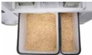
Dubbele opvang voor houtspanen en - stof
